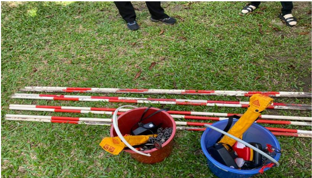
Gambar 2: Peralatan yang digunakan bagi kerja ukur rantai adalah seperti pancang jajar (untuk menandakan stesen), rantai Gunter, pita linen, persegi optik, panah dan kompas
