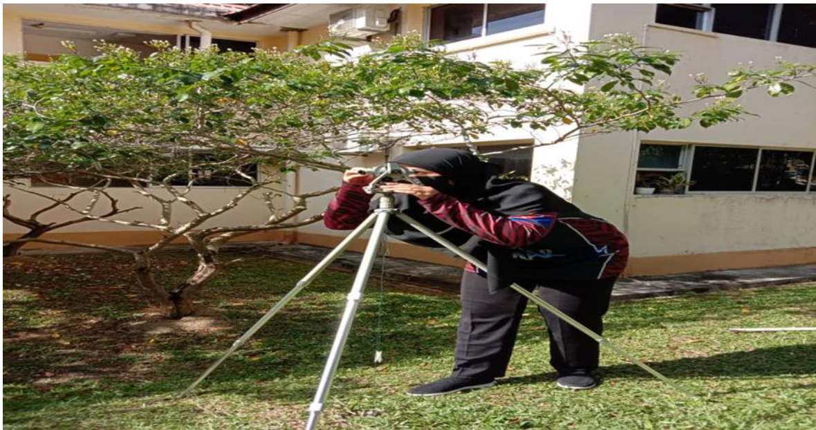
Gambar 4: Ahli kumpulan menggunakan persegi optik yang berfungsi atas prinsip pemantulan cahaya bagi menentukan sudut tepat bagi kawasan yang diukur
